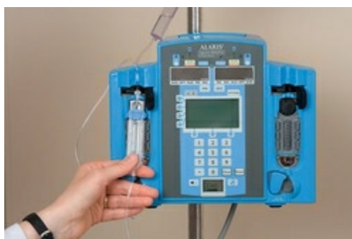
FIG. 59-2 Inserir equipo IV na câmara do mecanismo de controle.
