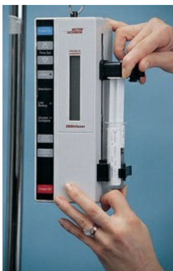
FIG. 53-3 Garantir que a seringa esteja presa após colocá-la na bomba de mini-infusão.
